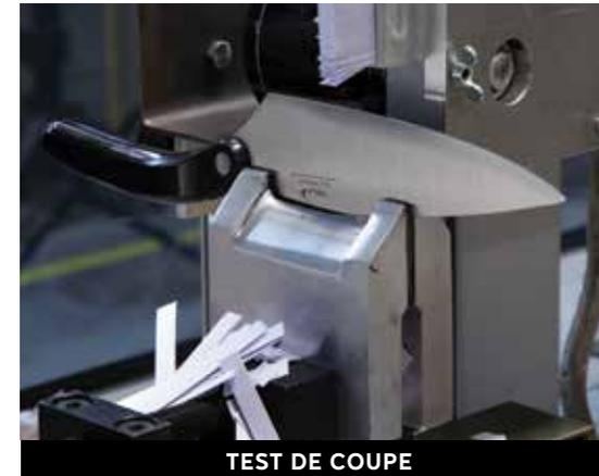
Déglon fait partie des rares fabricants de couteaux au monde à être équipé d'une machine normalisée de contrôle de la durée de coupe des couteaux.
